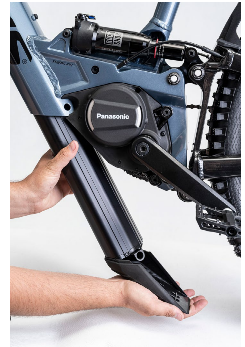
ABBILDUNG 3: RICHTIGES HALTEN DES AKKUS BEIM HERAUSZIEHEN
