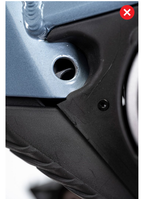
ABBILDUNG 6: ÜBERPRÜFUNG DER KONZENTRIZITÄT DER BOHRUNG IM RAHMEN UND IN DEM AKKU
