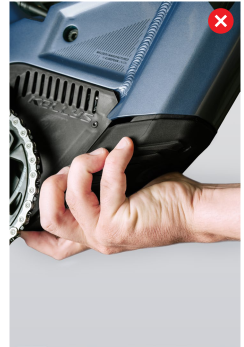
ABBILDUNG 8: ÜBERPRÜFUNG DER ÜBERLAPPUNG DER MOTORABDECKUNG MIT DER AKKUABDECKUNG AUF DER RECHTEN SEITE (ANTRIEBSSEITE)
