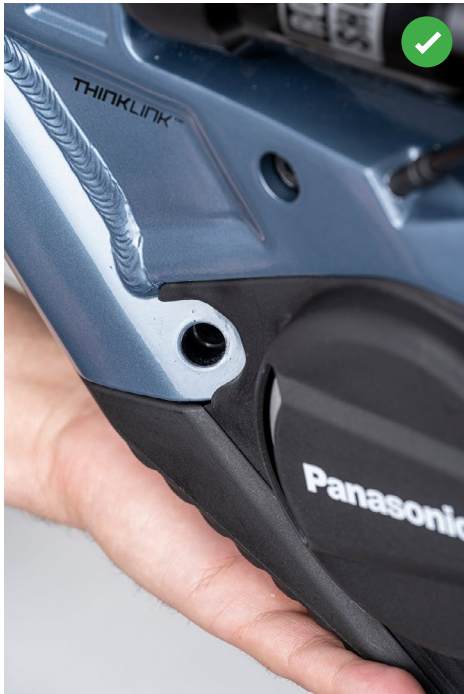
ABBILDUNG 7: ÜBERPRÜFUNG DER ÜBERLAPPUNG DER MOTORABDECKUNG MIT DER AKKUABDECKUNG AUF DER LINKEN SEITE (NICHTANTRIEBSSEITE)
