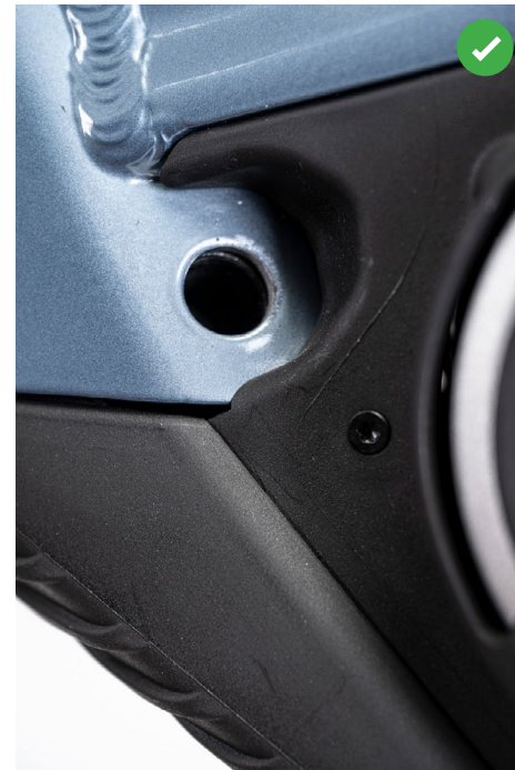
ABBILDUNG 6: ÜBERPRÜFUNG DER KONZENTRIZITÄT DER BOHRUNG IM RAHMEN UND IN DEM AKKU
