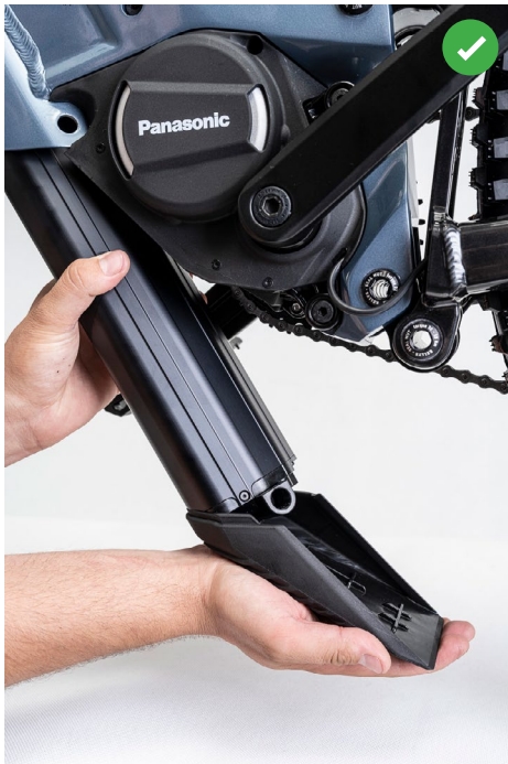
ABBILDUNG 4: RICHTIGES HALTEN DES AKKUS
