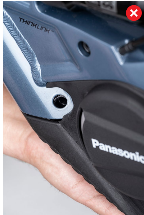
ABBILDUNG 7: ÜBERPRÜFUNG DER ÜBERLAPPUNG DER MOTORABDECKUNG MIT DER AKKUABDECKUNG AUF DER LINKEN SEITE (NICHTANTRIEBSSEITE)
