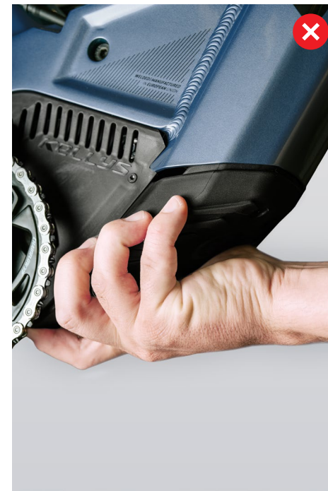
FIGURE 8: VÉRIFIER QUE LE CAPOT DU MOTEUR EST RECOUVERT PAR LE CAPOT DE LA BATTERIE SUR LE CÔTÉ DROIT (CÔTÉ ENTRAÎNEMENT)
