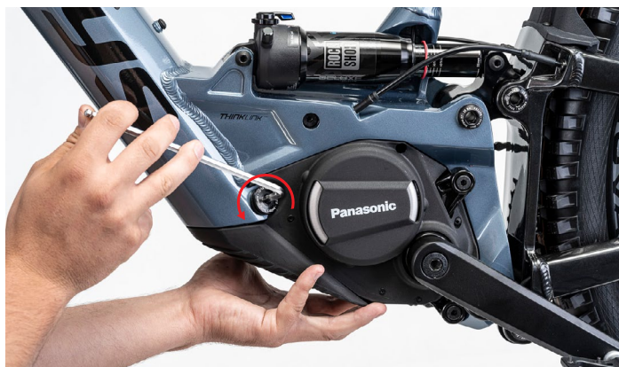
FIGURE 1: EMPLACEMENT DE LA VIS ET SENS DE ROTATION
