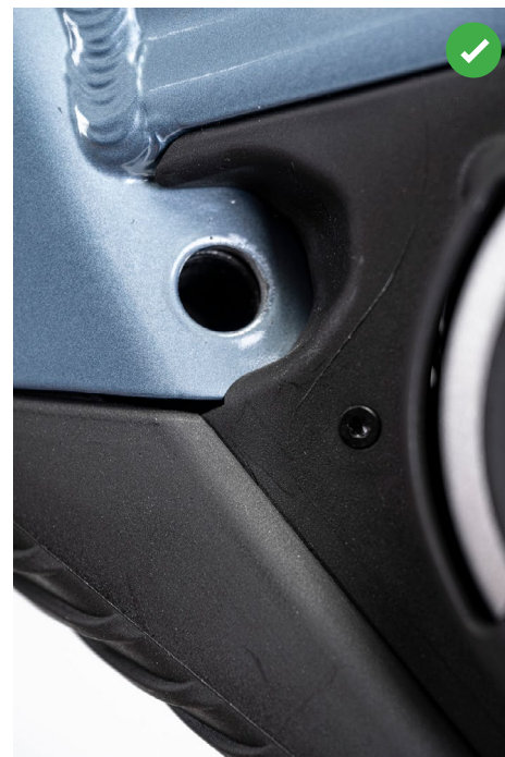
FIGURE 6: VÉRIFIER LA CONCENTRICITÉ DU TROU DU CADRE ET DE LA BATTERIE
