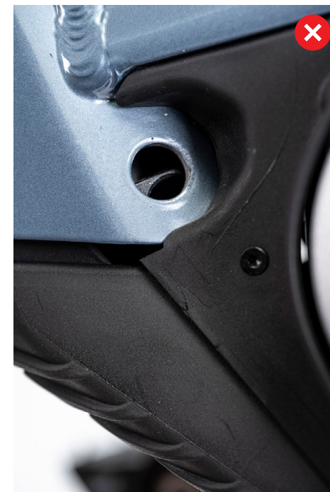
FIGURE 6: VÉRIFIER LA CONCENTRICITÉ DU TROU DU CADRE ET DE LA BATTERIE
