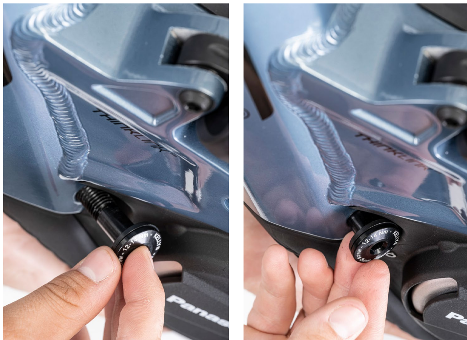
FIGURE 9: VIS INTRODUITE DANS LE CADRE
