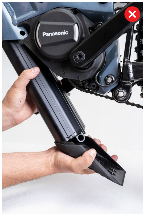
FIGURE 5: MANIÈRE INCORRECTE DE TENIR LA BATTERIE
