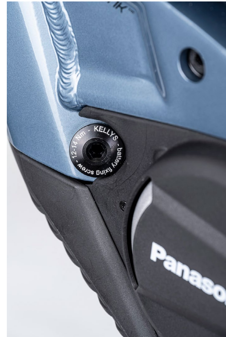
RYСУNEK 10: ŁEB ŚRUBY Z ZALECANYM MOMENTEM OBROTOWYM
