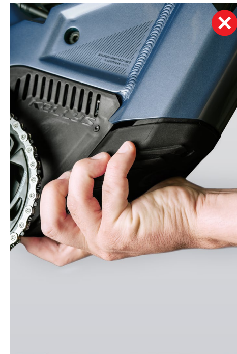
RYСУNEK 8: SPRAWDZENIE, CZY POKRYWA SILNIKA ZACHODZI NA POKRYWĘ AKUMULATORA PO PRAWIEJ STRONIE (STRONA NAPĘDU)
